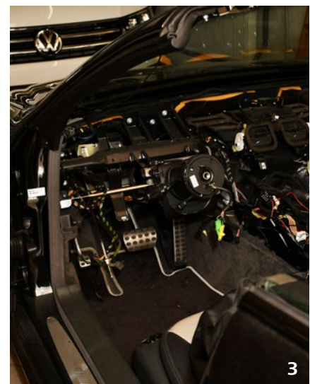
1) Steven Sailer's jüngstes Projekt: Der Mercedes SL 55 AMG V8 Compressor wird das neue Show-Car des Tiroilers für die kommende Highend in München. 2 + 3) Im ersten Schritt hat Sailer einmal die Verkleidung und das Armaturenbrett entfernt, bevor es ans Tüfteln geht.
