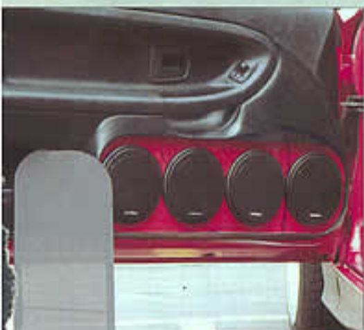
Je zwei Paare Rainbow W 130 wurden in den Türen eingebaut. Der Großteil der Elektronik findet im Kofferraum Platz.
