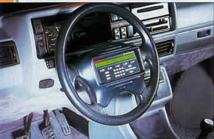
Das Bedienteil des Signalprozessors wurde in Maßarbeit ins Lenkrad eingepaßt. Damit läßt sich unter anderem die Lautstärke der Anlage einstellen, was Steven Sailer dazu veranlaßte, dem CD-Tuner im DIN-Schacht eine schwarze Abdeckung mit passendem CD-Schlitz zu verpassen.
